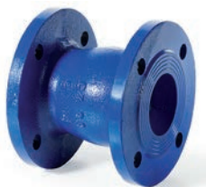
M16 Corpo: ghisa grigia - Otturatore: AISI 304 Body: cast iron - Shutter: AISI 304 DN40 - DN100 Guida: ottone Guide: (DN40 - DN100) brass DN125 - DN200 Guida: ghisa grigia Guide: (DN125 - DN200) cast iron
